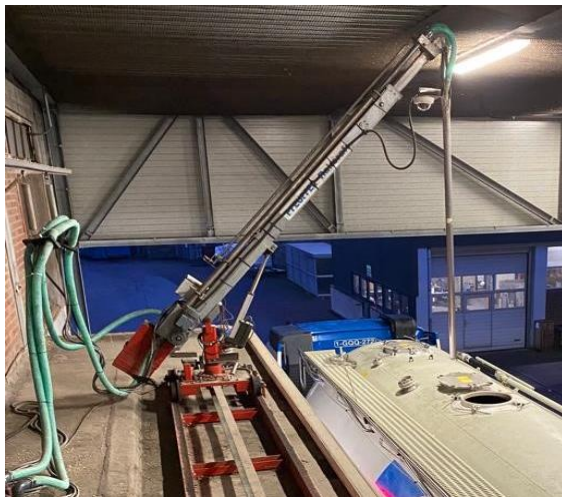
Voorbeeld van een meetmethode: gepompte meter aan monsterstok
