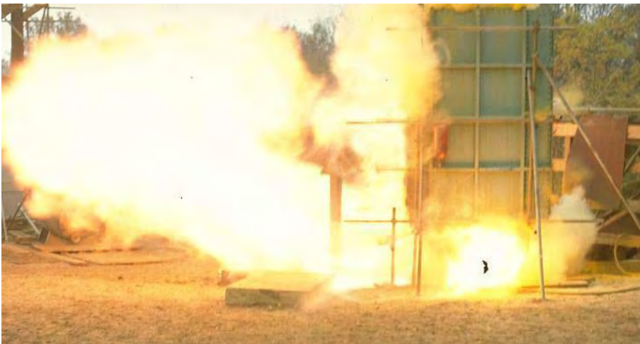
Foto 4: Explosie in filter met drukontlasting (Bron: Handboek Win Vent 2003)
